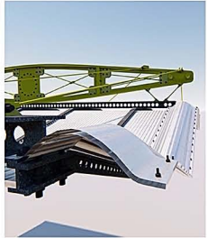
جزئیات پوشش بین دو سقف
