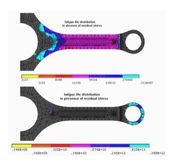
Fig12. Final fatigue analysis.
