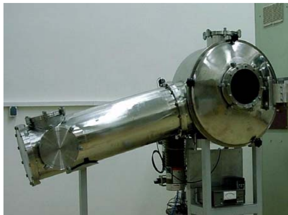
شکل ۱. دستگاه ذوب‌ریسی تحت گاز محافظ
