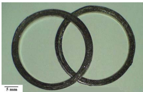
شکل ۴. نمونه‌ای از حلقه‌های تهیه شده برای اندازه‌گیری خواص مغناطیسی
