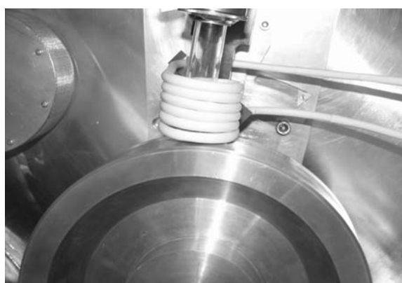
شکل ۲. پیچه القایی و دیسک مسی دستگاه ذوب‌ریسی
