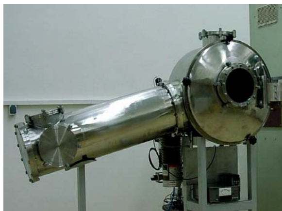
شکل ۱. دستگاه ذوب‌ریسی تحت گاز محافظ
