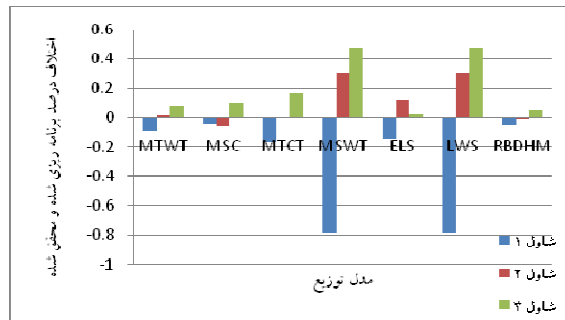
شکل ۱۰. اختلاف درصد برنامه‌ریزی شده و محقق شده تولید شاول‌ها برای کامیون ۱۵۰ تنی
