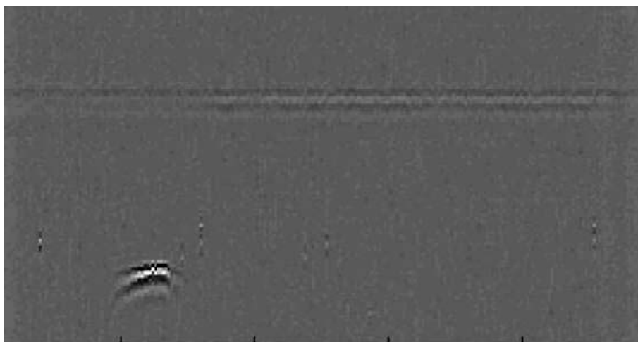
شکل ۶. روبش B قطعه اول با ۱ بازتابنده در نیمه پایینی
