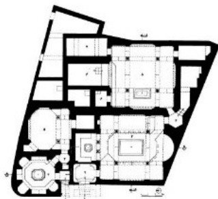
شکل ۱۰: چهارصفه‌ی نه‌گنبد در معماری حمام‌های دوره‌ی اسلامی الف. بیگ حمام در تسالونیک (مرکز مقدونیه)، عثمانی (مأخذ: کانتکی ۲۰۰۴، ۸۸ تصویر الف)
