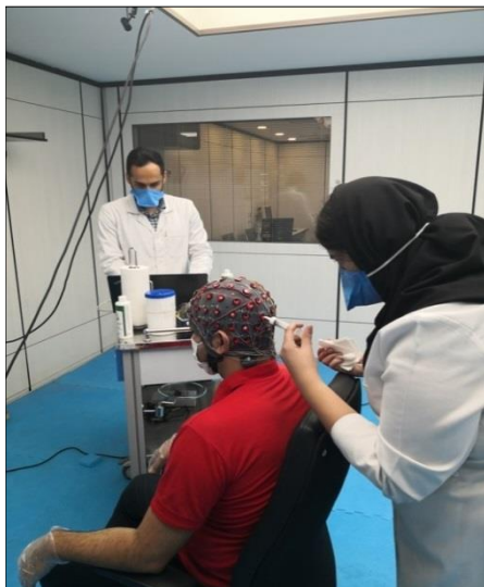
تصویر ۵. تصویر راست: نصب و آماده‌سازی کلاه EEG بر روی سر آزمودنی. تصویر چپ: تزریق ژل رسانا بر زیر الکترودها (ماخذ: نگارندگان)
