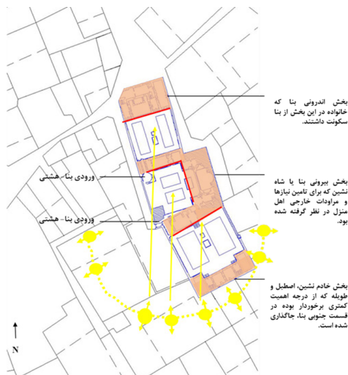
تصویر ۲. بررسی ملاحظات اقلیمی (نورگیری و جاگذاری توده های ساختمان های مسکونی) در خانه ی صادقی (مأخذ: نگارندگان)
